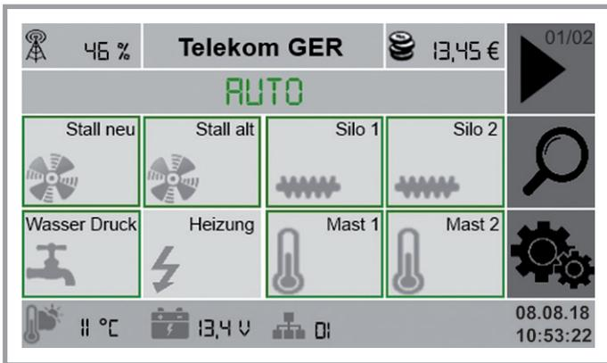
In der **Übersichtsmaske** werden klar strukturiert **alle wichtigen Zustände** angezeigt. Sie können den verwendeten Netzbetreiber, die Mobilfunk-Empfangsstärke, das Guthaben der Prepaid-Karte oder den aktuellen Akkuzustand erkennen. Alle **konfigurierten Alarme** werden farblich in **Abhängigkeit ihres Zustandes** dargestellt.
