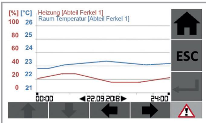
Alle **betriebsrelevanten Daten** werden **kontinuierlich abgespeichert** und bis zu **12 Monate gepuffert**. Der Bediener kann individuell Messwerte auswählen, welche in einem Kurvendiagramm dargestellt werden. Mit Hilfe der „Pfeil-Tasten“ wird entsprechend zeitlich zurückgeblättert.
