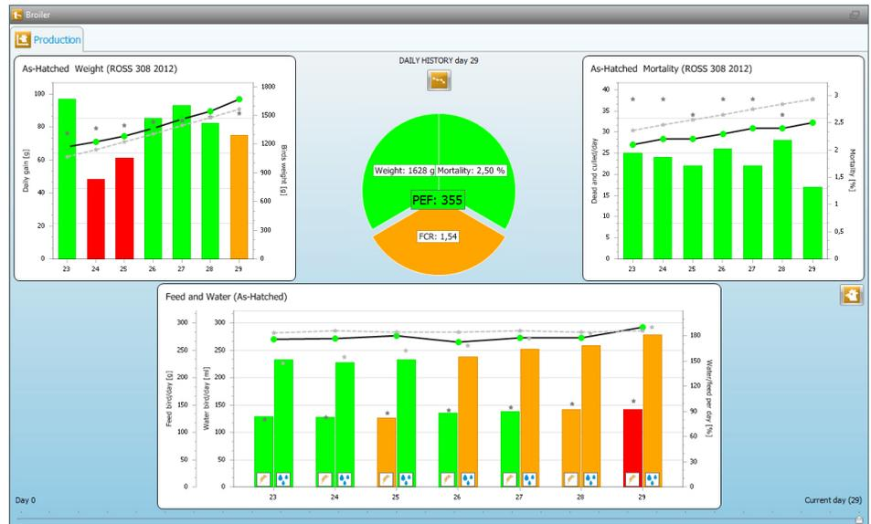
Die Schlüsselwerte wie Futterumsatz (FCR) und Effektivitätsfaktor (PEF) werden auf einem zentralen Bildschirm mit farblich gekennzeichnetem Status angezeigt. Die gesamte Bildschirmdarstellung ist dynamisch und wird der Produktion laufend angepasst.
