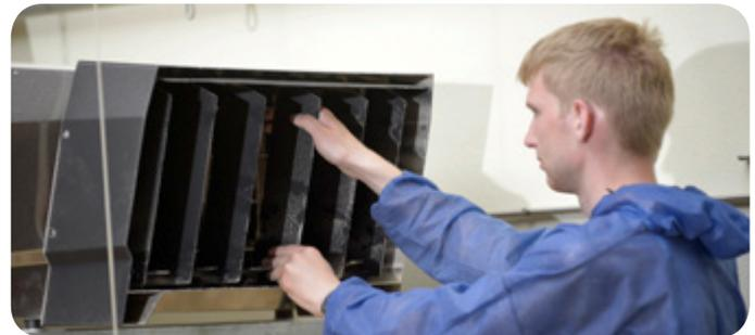
Das Luffleitblech ist ein Rahmen in dem mehrere Bleche in verschiedener Ausrichtung angeordnet sind. Er wird einfach vorn an der Austrittsöffnung am Thermorizer aufgesteckt. Die Bleche lassen sich horizontal und vertikal justieren. Damit wird der erwärmte Luftstrom in die gewünschte Richtung gelenkt. Durch die bessere Luftverteilung wird eine gleichmäßige Wärme im Stall erreicht und die Tiergesundheit verbessert. Außerdem bleibt die erwärmte Luft länger im Bodenbereich.
