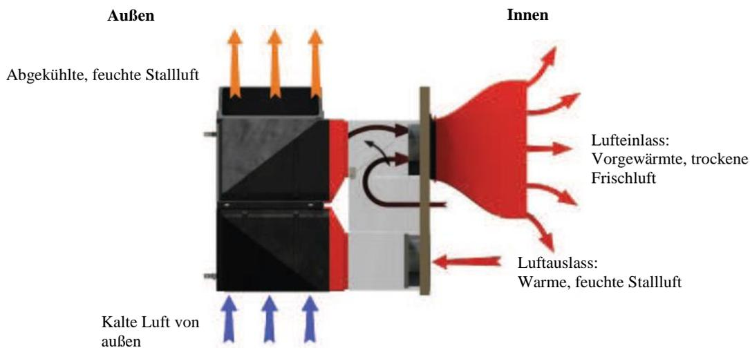
**Abb. 1: Skizze der Funktionsweise einer Wärmerückgewinnung**
