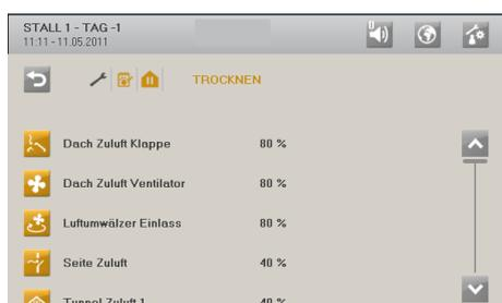
Trocknen ist eine Kombination aus Lüftung und Wärmezufuhr. Je mehr Wärme dem Stall zugeführt wird, desto schneller trocknet er.
