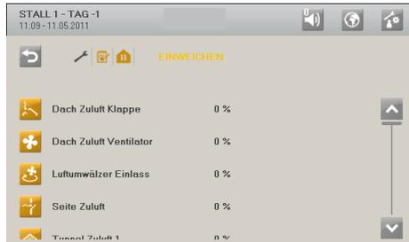
Die Einweichfunktion befeuchtet den Stall mit Wasser und löst so Staub und Schmutz. Dadurch wird nicht nur die nachfolgende Reinigung erleichtert, sondern auch die Staubmenge reduziert.
