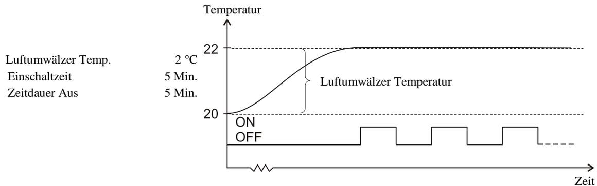
**2.10.3 Regelung des Luftumwalzers mit einer Heizung**
