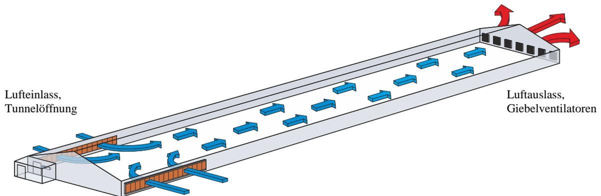
Abbildung 3: Tunnellüftung
