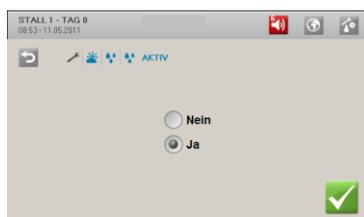
Ist die Feuchteregelung abgeschaltet, regelt der DOL 539 die Lüftung nur nach der Innentemperatur.
