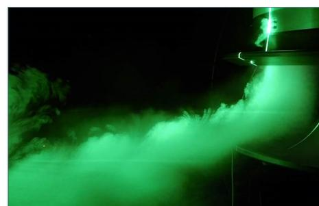
DA 60 Einblaseeinheit ohne Zwischenplatte
