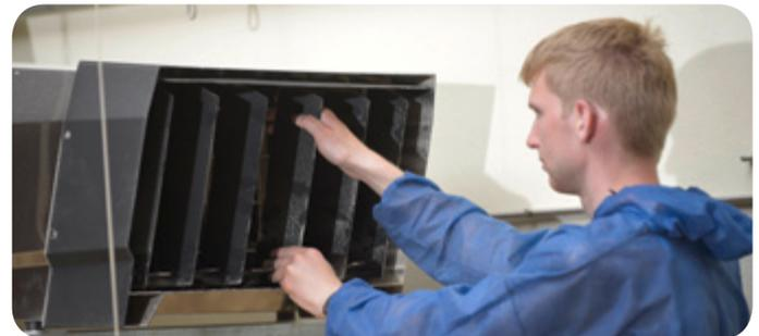
Le diffuseur d'air est un cadre où sont disposées plusieurs tôles orientées dans plusieurs sens. Il est monté aisément à l'avant sur l'ouverture de sortie du Thermoizer. Les tôles sont réglables dans le sens horizontal et vertical. Cela permet de diriger le flux d'air chaud dans le sens souhaité. Une meilleure répartition de l'air garantit une chaleur homogène dans l'étable et contribue à la santé des animaux. De plus, l'air chaud reste plus longtemps au niveau du sol.
